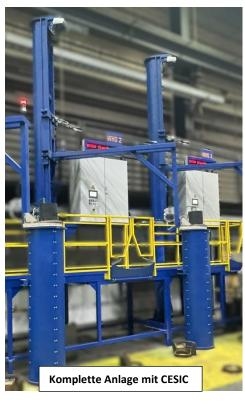
Anschlusswert von 50 kW statt über 100 kW mit einer gasbeheizten Anlage bei einer bedarfsgerechter Leistungsregelung
